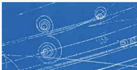
FIGUR 3: Gamla apparater: bubbelkammare på Fermilab. Bubbelkammarmarkort från Berkeley Lab. Man ser en foton sönderfalla i elektron-positron-par. En elektron slungas ut från en atom samtidigt, se nedan.
